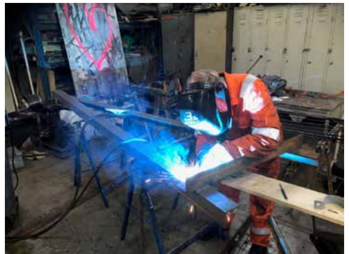
Het lassen van de steunen in de werkplaats
